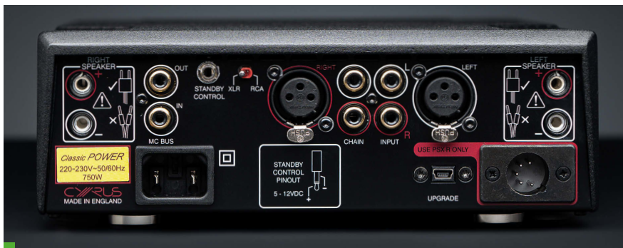
Do Classic Power podłączmy wyłącznie kable oprawione wtykami BFA lub bananowymi.
