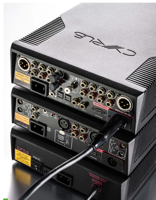
Zasilacz PSX-R 2 można podłączyć zarówno do przedwzmacniacza, jak i końcówki mocy. Wypróbowaliśmy obydwie konfiguracje.
