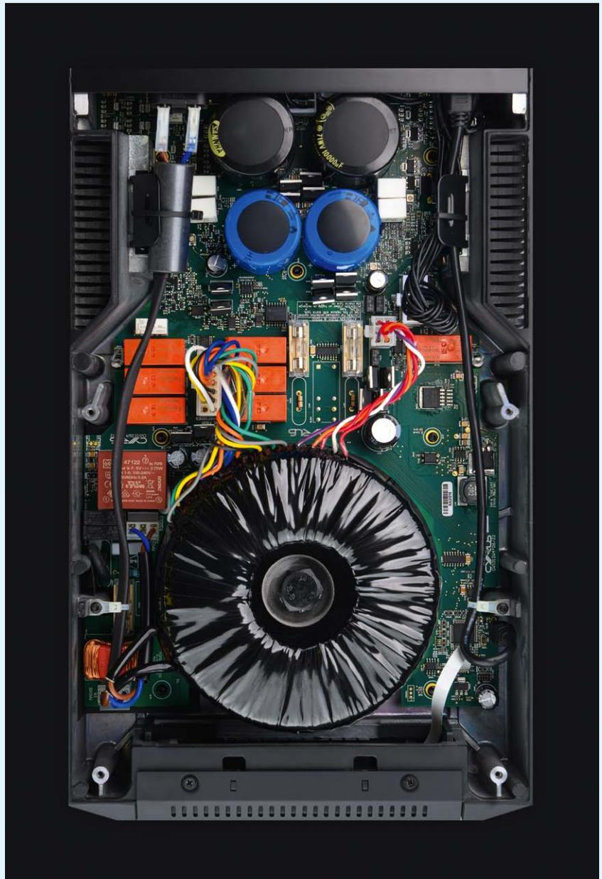
**KERNGESCHÄFT:** Das externe Netzteil PSU-XR dominiert im Inneren der grosse Ringkern-Transformator. Über verschiedene Abgriffe werden Baugruppen versorgt.
